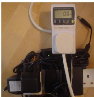
Fig.11.2: Diese fünf Ladegeräte – drei für Handys, eines für einen Handheld PC, eines für einen Laptop – zeigten weniger als ein Watt auf meinem Messgerät.
