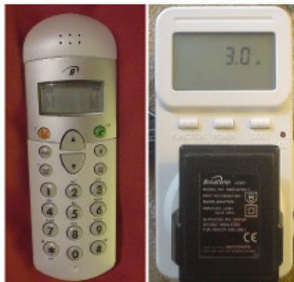
Fig.11.3: Dieses verschwenderische kabellose Telefon und sein Ladegerät brauchen 3 W wenn sie eingesteckt bleiben. Das sind 0,07 kWh/d. Bei Stromkosten von 10 Cent pro kWh kostete das 3W-Tröpfeln 3€ pro Jahr.
