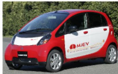
Fig.20.38: Der i MiEV von Mitsubishi Motors Corp. Er hat einen 47 kW Motor, wiegt 1080 kg und läuft 130 km/h Spitze.
