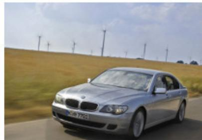
Fig.20.26: Der BMW Hydrogen 7. Energieverbrauch: 254 kWh pro 100 km. Foto von BMW.
