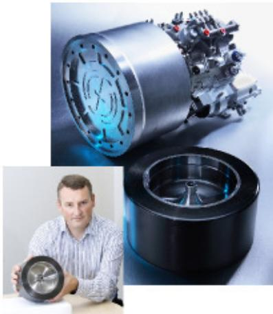
Fig.20.18: (links) Ein regeneratives Bremssystem mit Schwungrad. Fotos mit freundlicher Genehmigung von Flybrid Systems
