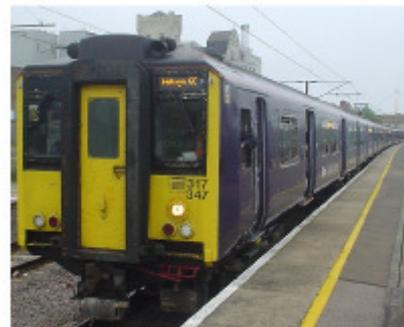
Fig.20.4: Dieser 8-Waggon-Zug verbraucht bei seiner Höchstgeschwindigkeit von 161 km/h **1,6 kWh pro 100 Passagier-km**, wenn er voll ist.
