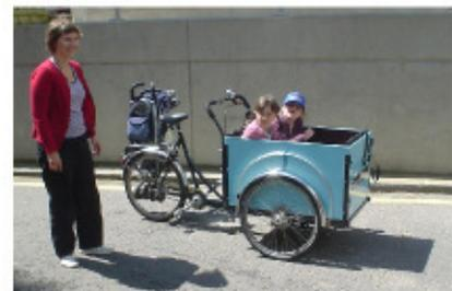
Fig.20.3: „Baby an Bord“ Diese Art des Transports hat Energiekosten von **1 kWh pro 100 Personen-km**.
