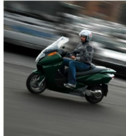
Fig.20.44: Vectrix: **2,75 kWh auf 100 km**. Foto von [www.vectrix.com](http://www.vectrix.com)
