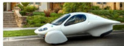
Fig.20.40: Der Aptera. **6 kWh auf 100km**. Foto von [www.aptera.com](http://www.aptera.com)
