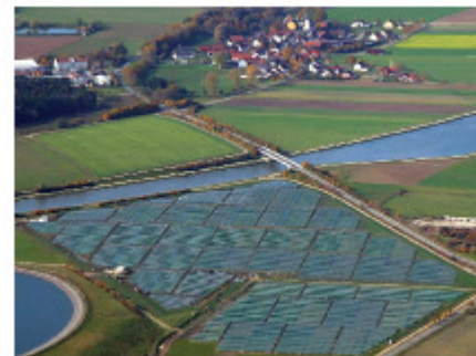
Fig.6.7: Eine PV-Freiflächenanlage mit 6,3 MW (peak), der Solarpark in Mühlhausen, Bayern. Die mittlere Leistung pro Landflächeneinheit dürfte um die 5W/m 2 liegen. Foto: SunPower.
