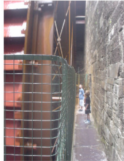
Fig.8.4: Ein 60 kW Wasserrad
