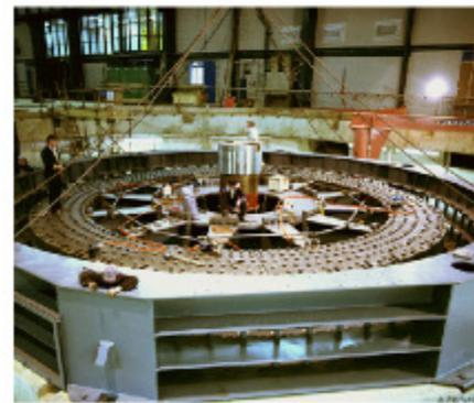
Fig.26.15: eines der beiden Schwungräder an der Fusionsforschungsstätte Culham, in Bau. Foto EFDA-JET. [www.jet.efda.org](http://www.jet.efda.org)
