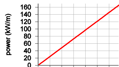
Fig.F.1: Fakten zu Wellen im tiefen Wasser. In allen vier Diagrammen ist die horizontale Achse die Wellengeschwindigkeit in m/s. Die einzelnen Grafiken zeigen (von oben nach unten): Windgeschwindigkeit (im m/s), die erforderlich ist um Wellen dieser Geschwindigkeit zu erzeugen; Periode der Welle (in Sekunden); Wellenlänge (in m) und Leistungsdichte (in kW/m) einer Welle mit 1 m Amplitude.
